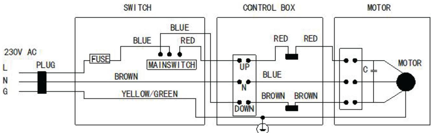
إذا كانت الشاشة الآلية تعمل بجهاز تحكم عن بعد، يرجى الرجوع إلى الرسم التخطيطي أدناه لمعرفة التوصيل الكهربائي الصحيح.
