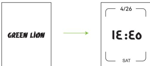
٢. أثناء تشغيل الجهاز، اضغط مع الاستمرار على الزر لمدة ثانيتين لعرض "Restart Options" على الشاشة. عند اختيار "Shutdown"، سيتم إيقاف تشغيل شاشة LCD وإيقاف الجهاز بالكامل. أما اختيار "إعادة التشغيل"，فسيؤدي إلى إعادة تشغيل الجهاز وإرجاع شاشة LCD إلى واجهة البدع.
