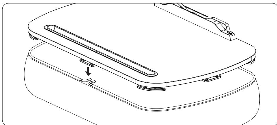
بمجرد إزالة الحلقة الفولاذية، يمكنك إزالة الوسائد من اللوحة للتنظيف.
