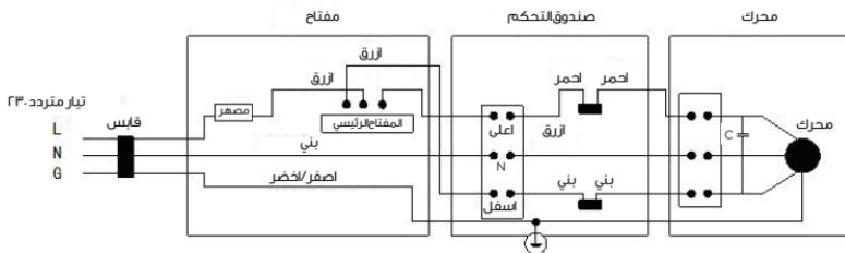
إذا كانت الشاشة الآلية تعمل بجهاز التحكم عن بعد، يرجى الرجوع إلى الرسم التخطيطي أدناه لمعرفة كيفية التوصيل الكهربائي.
